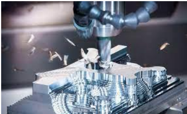
Рисунок 4.9 - Виготовлення металевих моделей на верстатах з ЧПУ
