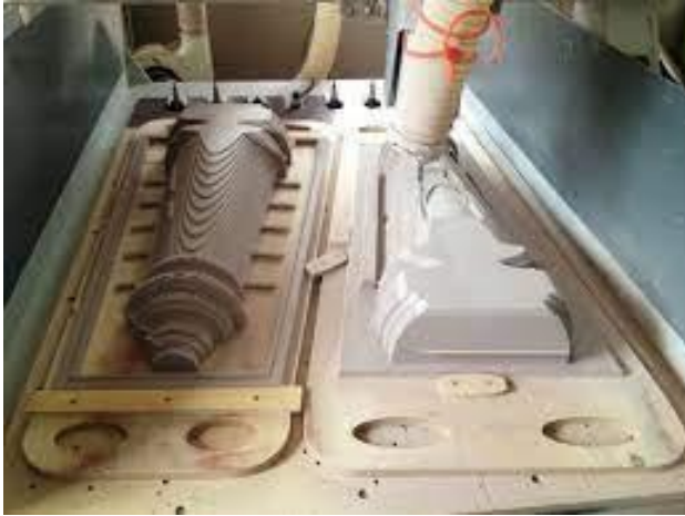
Рисунок 4.8 - Виготовлення моделей з деревини на верстатах з ЧПУ
