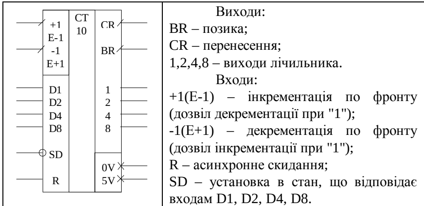
Рисунок 6.3 – УГП і призначення виводів KP1533IE6
