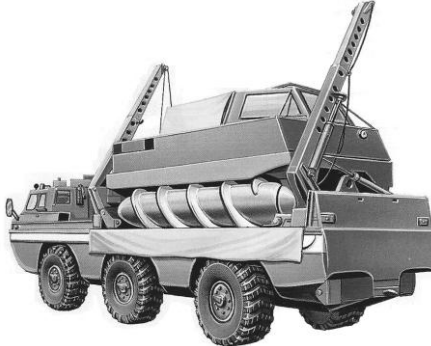
Рисунок 1.3 - Снігоболотохід 2906 комплексу «Синяя птица» в кузові вантажного колісного транспортеру 4906. Швидкість по дорозі - до 80 км/год., на плаву - до 9 км/год.
