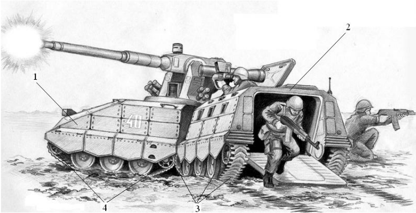
1 - перша ланка; 2 - друга ланка; 3 - елементи рушія першої ланки; 4 - елементи рушія другої ланки
