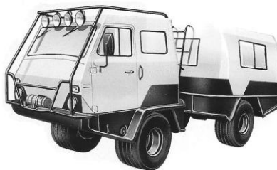
Рисунок 1.4 - Зчленований снігоболотохід СБХ-2 «Атака»: вантажопідйомність - 0,5 т, двигун - дизельний, 52,6 к.с., швидкість - до 45 км/год.
