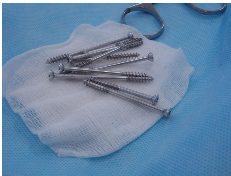
Рисунок 6.1 – Малеолярний гвинт D-3,5 мм, виготовлений з модифікованого промислового магнієвого сплаву МЛ-10
