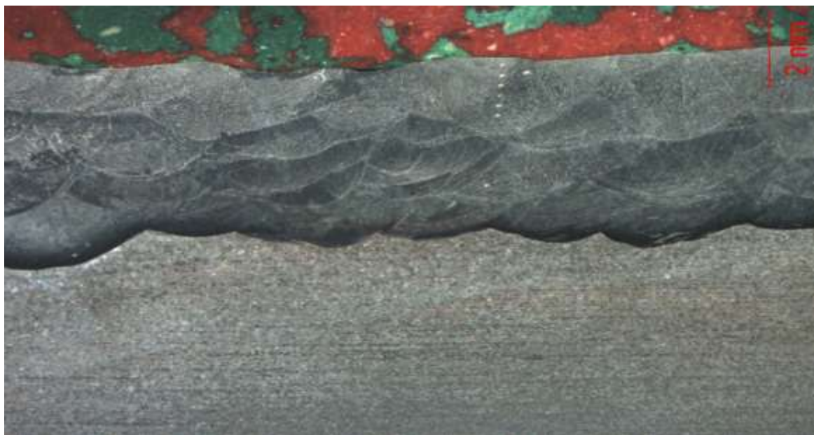
Рисунок 4.2 – Фото шліфа наплавленого шару металу струмоведучим дротом \times 6,5
