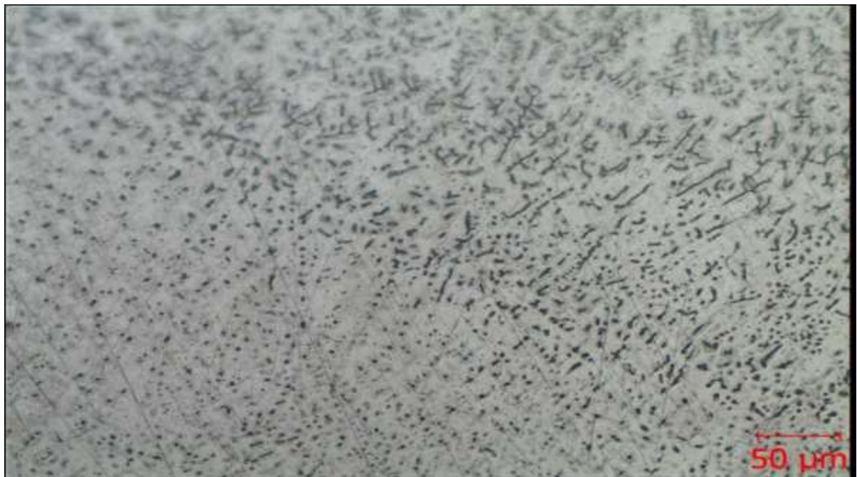
Рисунок 4.5 – Мікроструктура наплавленого струмоведучого дроту ПП-Нп-150Х \times 500
