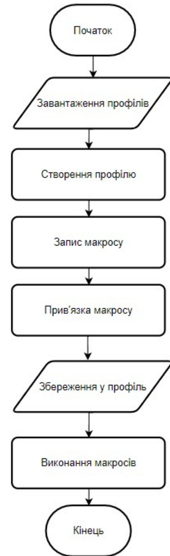
Рисунок 3.2 — Схема функціонування програмного забезпечення
