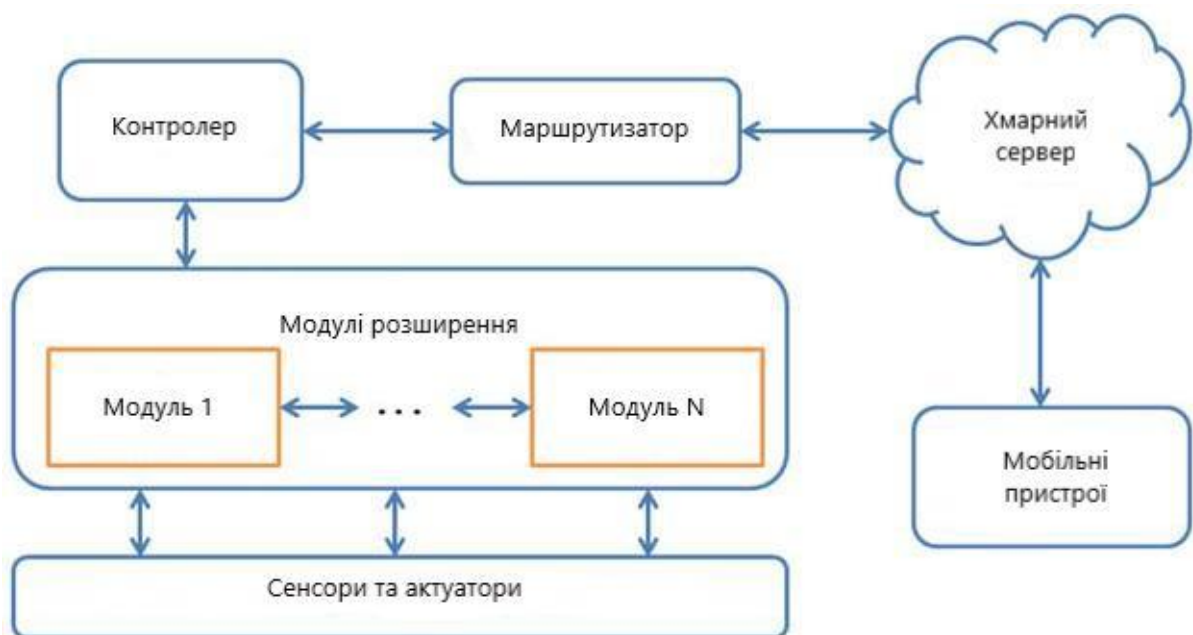
Рисунок 1.4 – Структура апаратного забезпечення СДА з функцією віддаленого керування [18]
