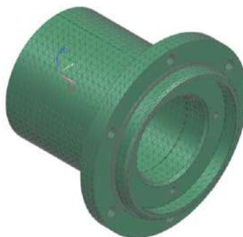
Рисунок 2.8 – 3D-модель, розбита на сітку кінцевих елементів
