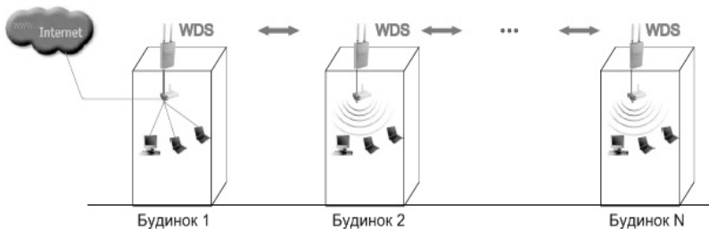
Рисунок 1.4 – Топологія типу "шина"
