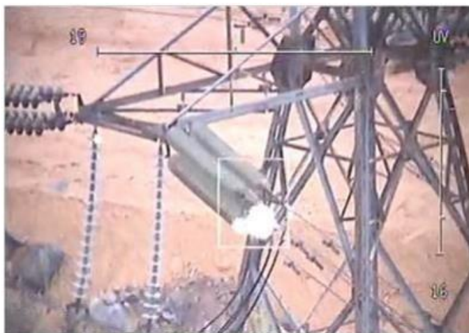
Рисунок 1.3 – Фото ЛЕП УФ камерою для моніторингу розрядної активності
