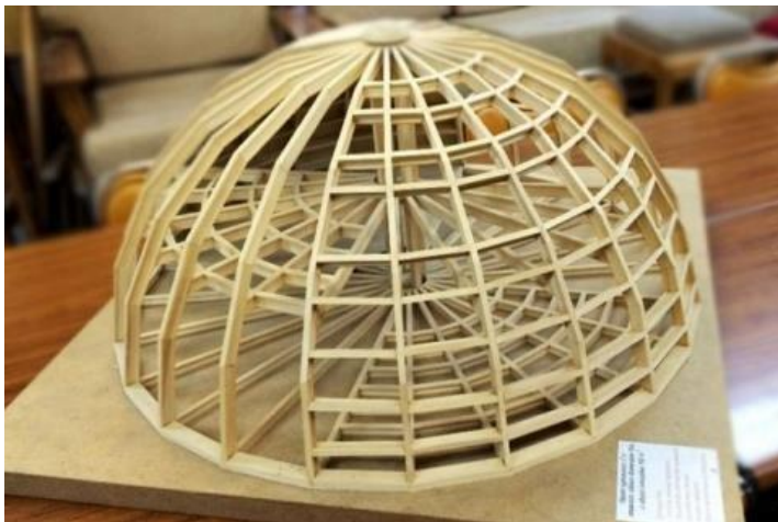
Рисунок 4.1 - Технологія будівництва купольних будинків без цвяхів, Владивосток, Росія
