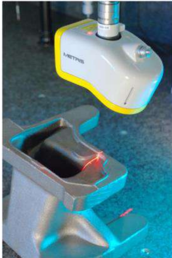
Рисунок 5.9 – Односмуговий лазерний сканер для KIM LC60Dx (Nikon) [15]
