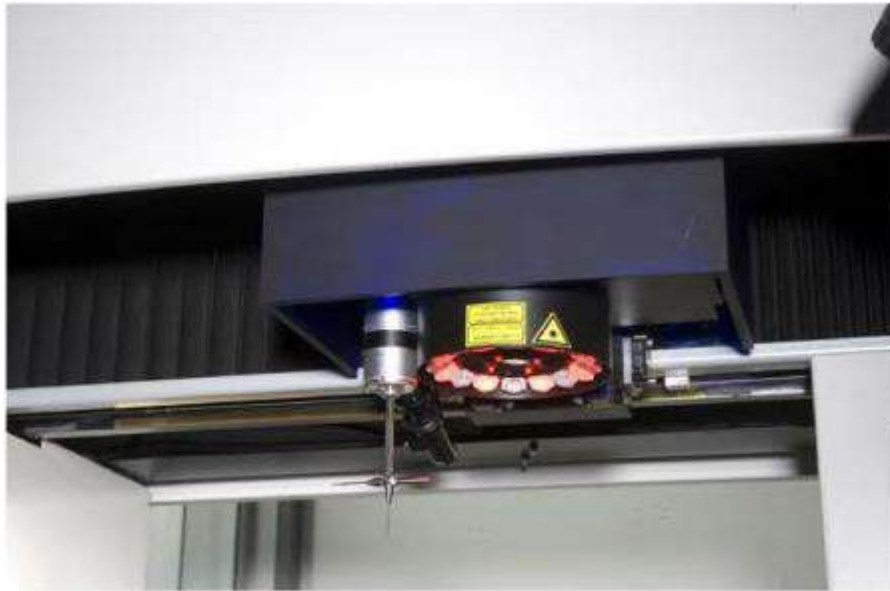
Рисунок 5.8 – Комбінована вимірювальна система [15]
