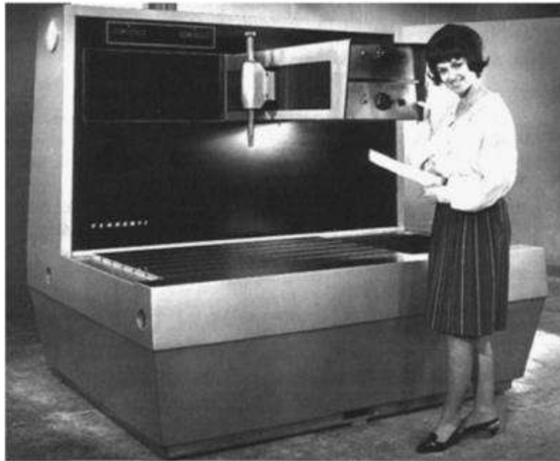
Рисунок 5.1 – Координатно-вимірювальна машина виробництва компанії «Ferranti, Ltd.» (Великобританія, в даний час "International Metrology Systems, Ltd.") [15]
