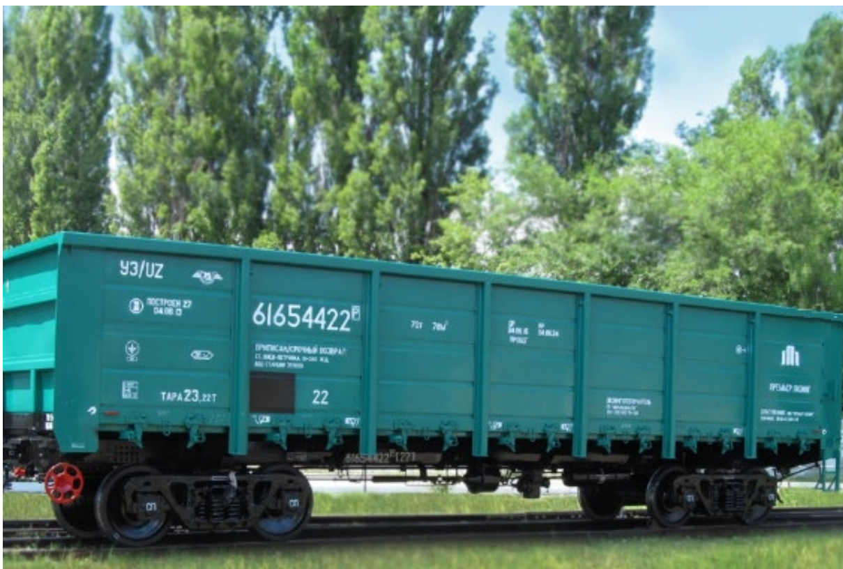
Рисунок 2.3 - Піввагон моделі 12-783 Крюківського вагонобудівного заводу
