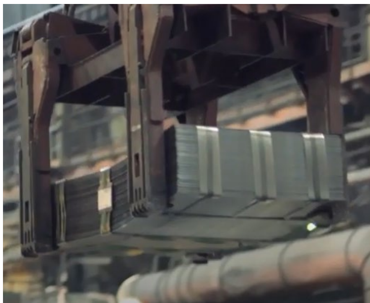
Рисунок 1.9 – Переміщення листового прокату у пачках
