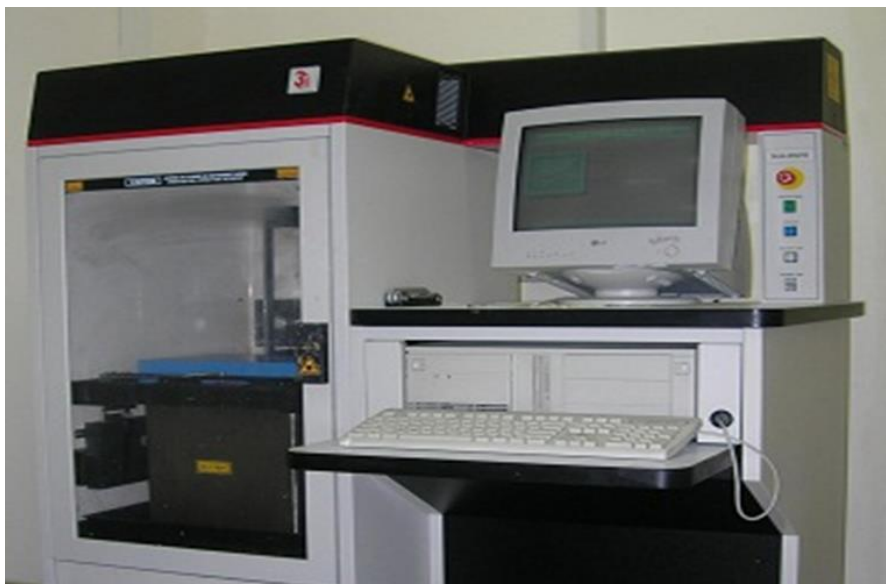
Рисунок 1.2 – Апарат SLA-250 [ www.orgprint.com ]
