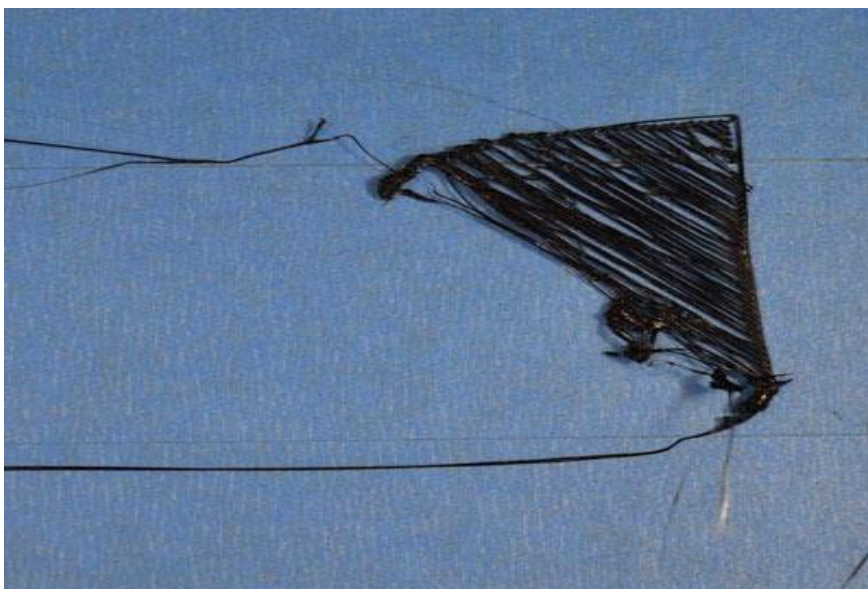
Рисунок 3 – 13 Приклад проблеми коли перші шари не прилипають до платформи 3D-принтера. [ https://3dpt.ru ]
