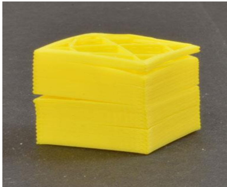
Рисунок 3 – 17 Приклад проблеми, коли шари розділяються і розщеплюються [ https://3dpt.ru ]
