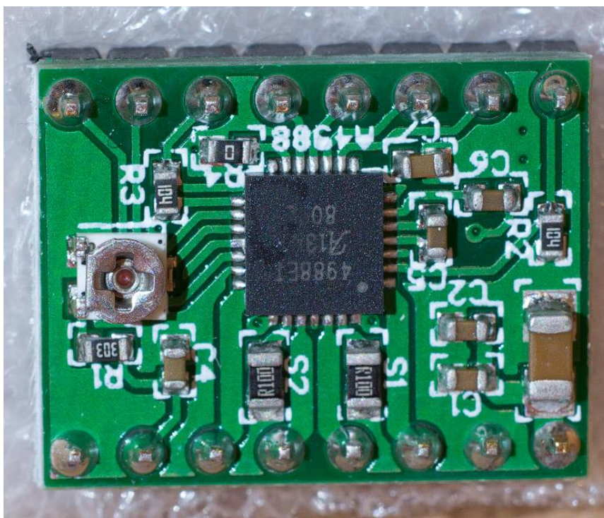
Рисунок 2.10 – Драйвер крокового двигуна A4988
