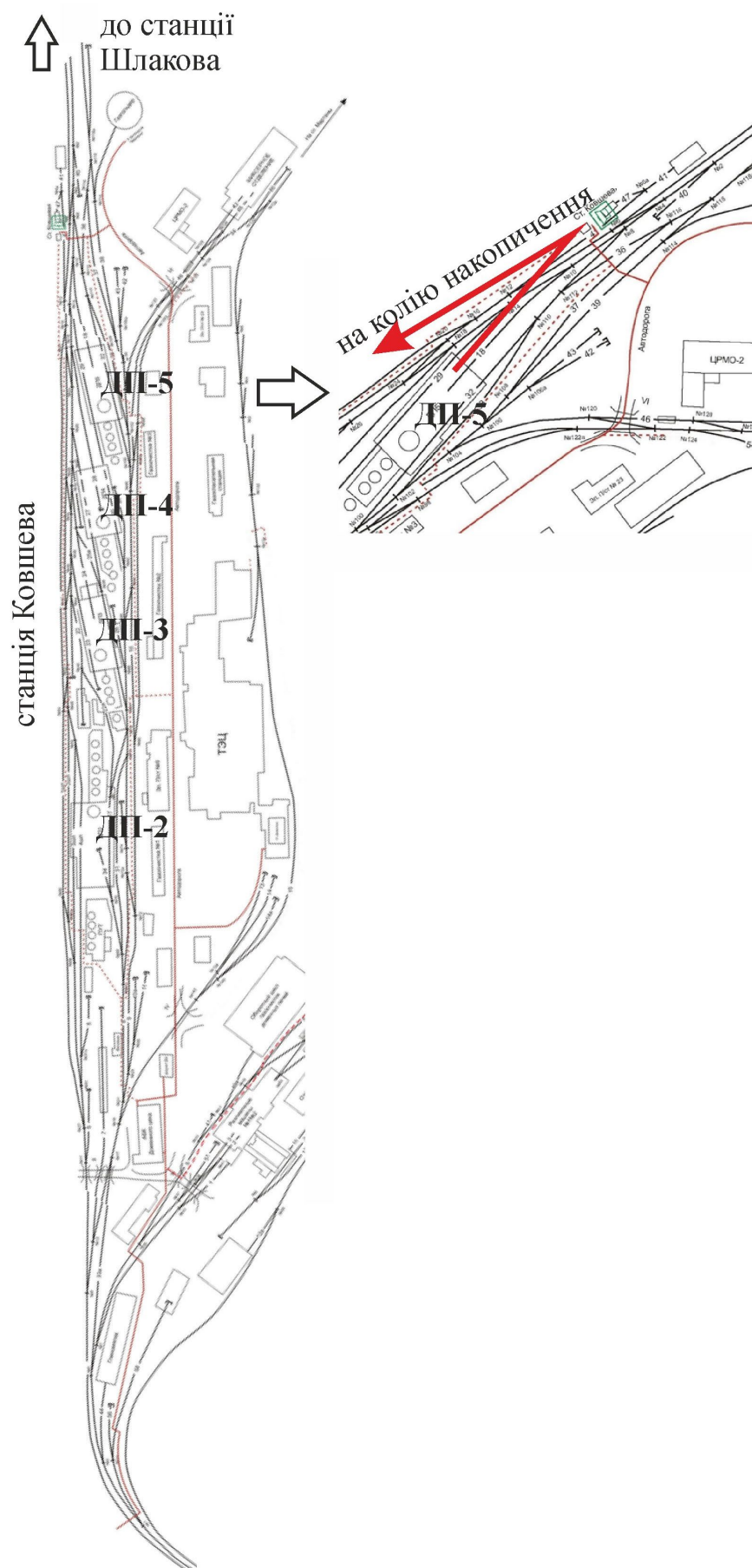
Рисунок 2.1 – Схема постановки шлаковозів на колію накопичення
