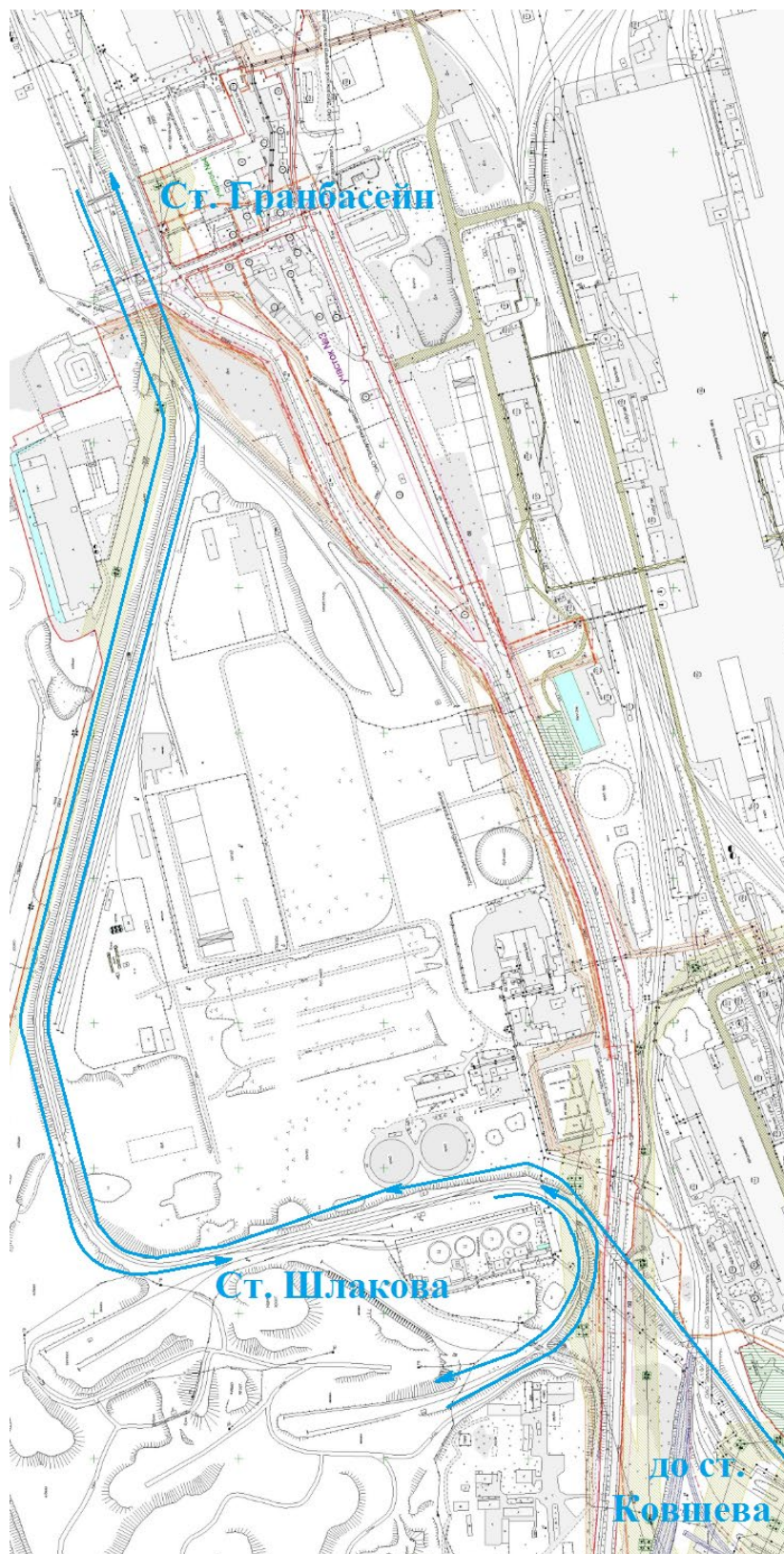
Рисунок 2.2 – Схема руху шлаковозних поїздів
