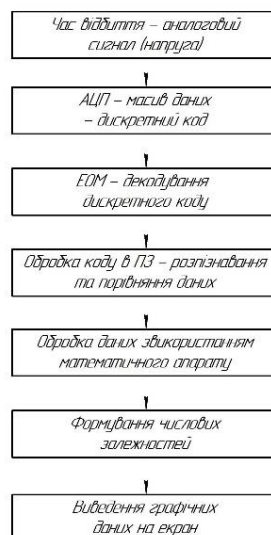
Рисунок 4.5 – Схема шляху проходження даних
