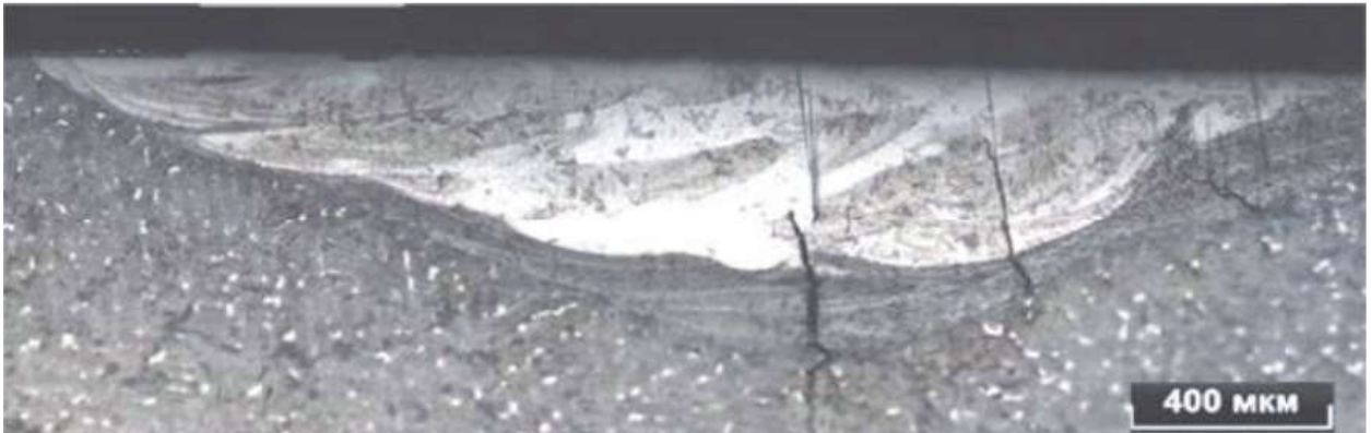
Рисунок 3.10 - Зона лазерного плавлення з виконанням одного проходу без подачі присадного матеріалу
