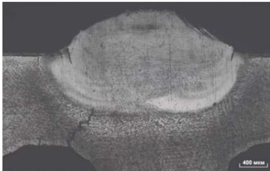
Рисунок 3.11 - Зовнішній вигляд шліфа зони аргонодугового підварювання
