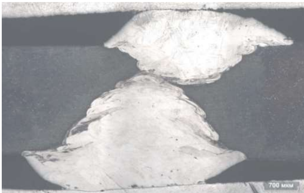
Рисунок 3.9 - Зовнішній вигляд травленого шліфа лазерного наплавлення, виконаного за місцем наскрізьної тріщини
