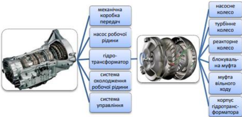
Рисунок 2.6 – Пристрій коробки передач з автоматичним вмиканням передач
