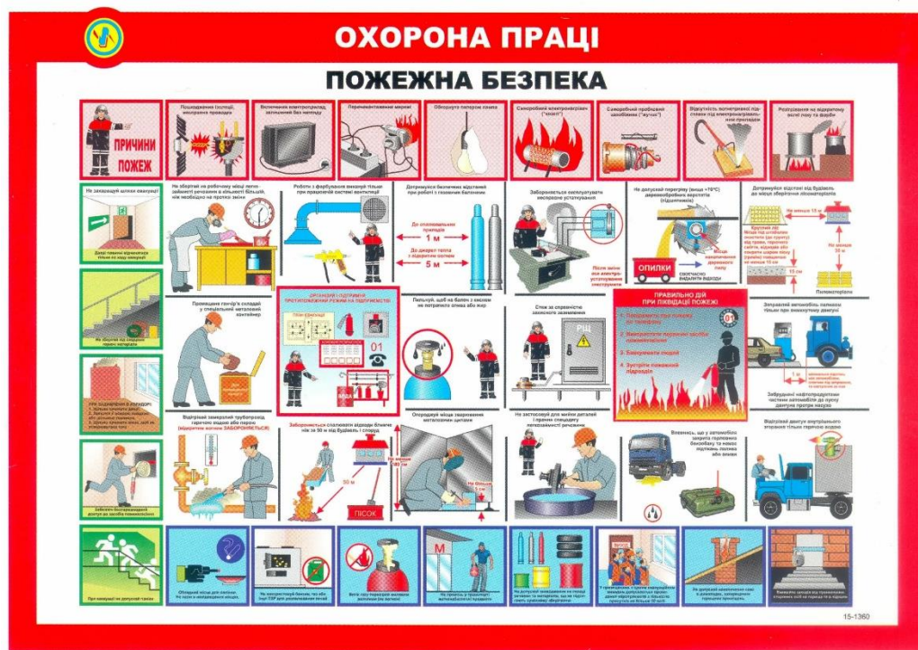
Рисунок 5.2 – Пожежна безпека на будівництві
