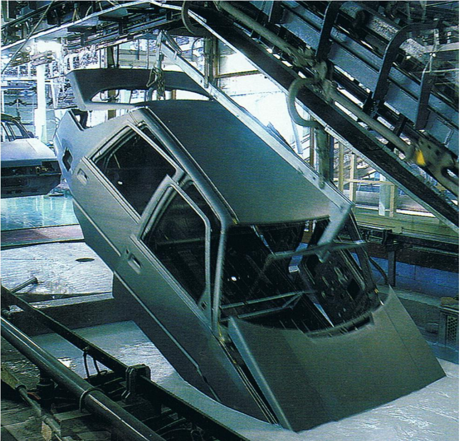
Рисунок 9.26 - Лінія фарбування кузовів
