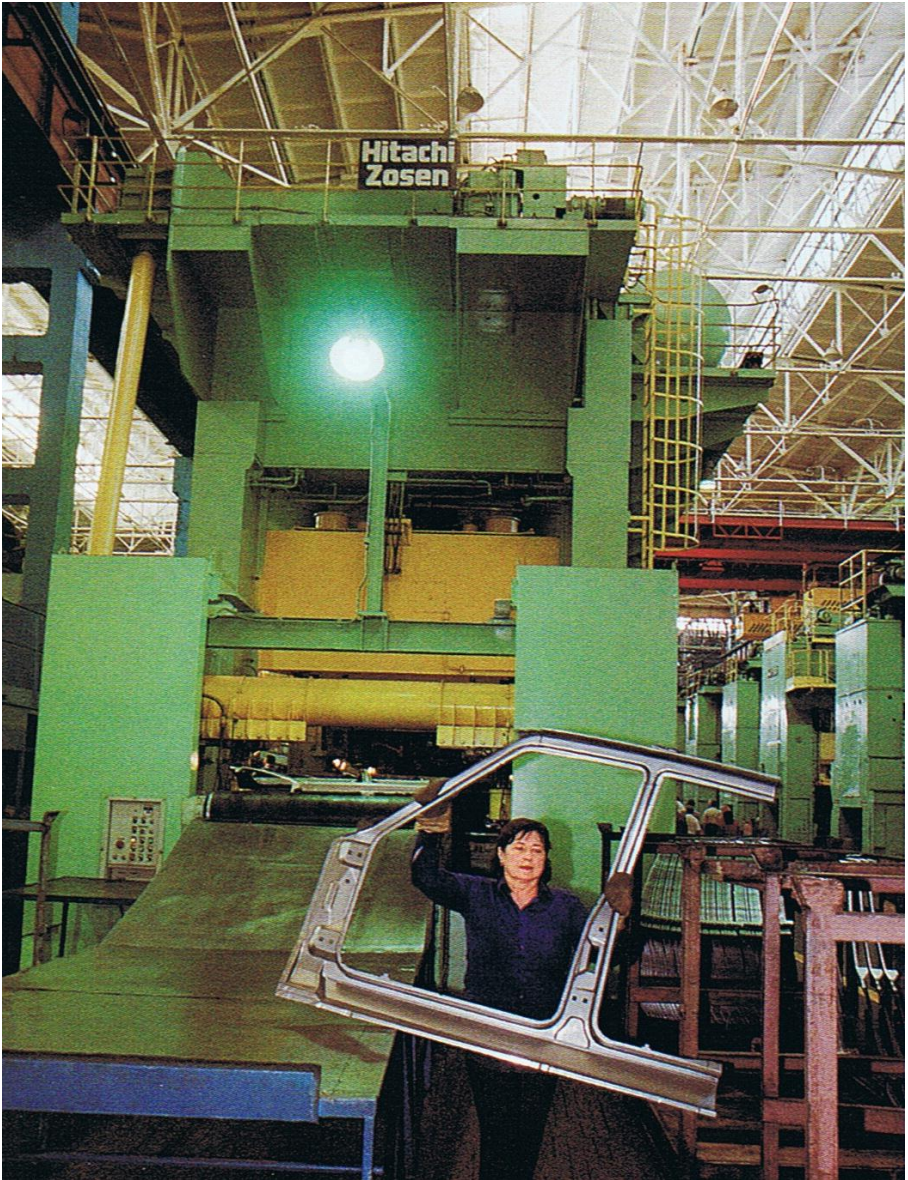
Рисунок 9.23 - Трьохкоординатний прес (поточна лінія) фірми Hitachi Zosen
