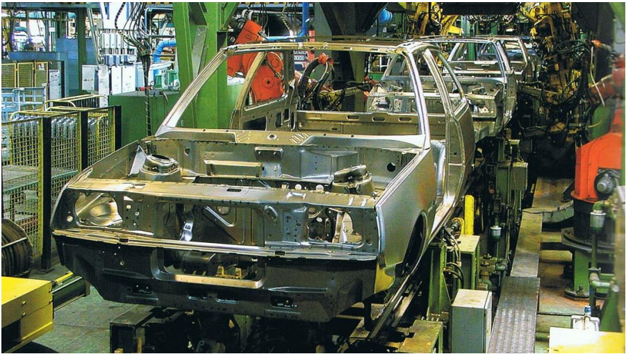
Рисунок 9.24 - Роботизована лінія зварювання автомобіля
