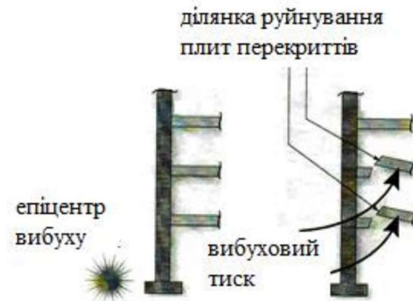
Рисунок 6.2 – Основне руйнування залізобетонного перекриття
