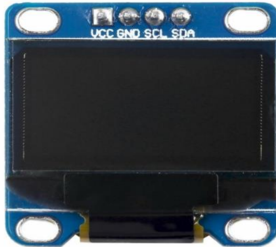
Рисунок 3.8 – OLED дисплей 0.96" I2C 128x64 [47]
