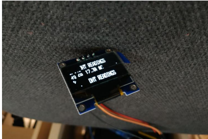
Рисунок 6.6 – Виведення на дисплей даних щодо температури у приміщенні
