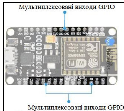
Рисунок 2.6 – Мультиплексовані виходи GPIO плати NodeMCU ESP8266 [19]
