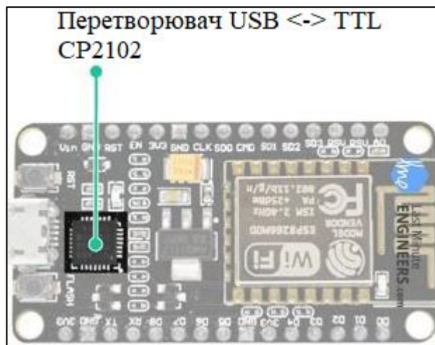
Рисунок 2.8 – Перетворювач USB↔TTL CP2102 [19]
