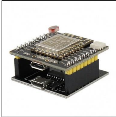
Рисунок 2.10 – Модуль ESP8266 Witty Cloud [20]
