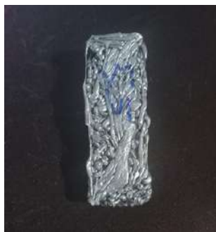
Рисунок Б.12 - Нашарування пластику при перебільшеній екструзії
