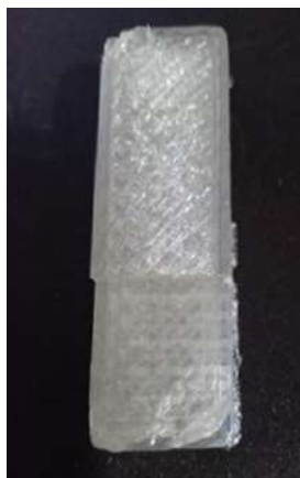
Рисунок Б.11 – Скол, який виник при фрезеруванні
