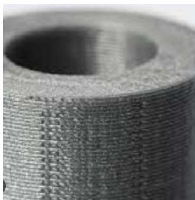
Рисунок 1.7 - Слої надрукованої деталі FDM методом
