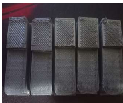
Рисунок Б.12 - Нашарування пластику при перебільшеній екструзії
