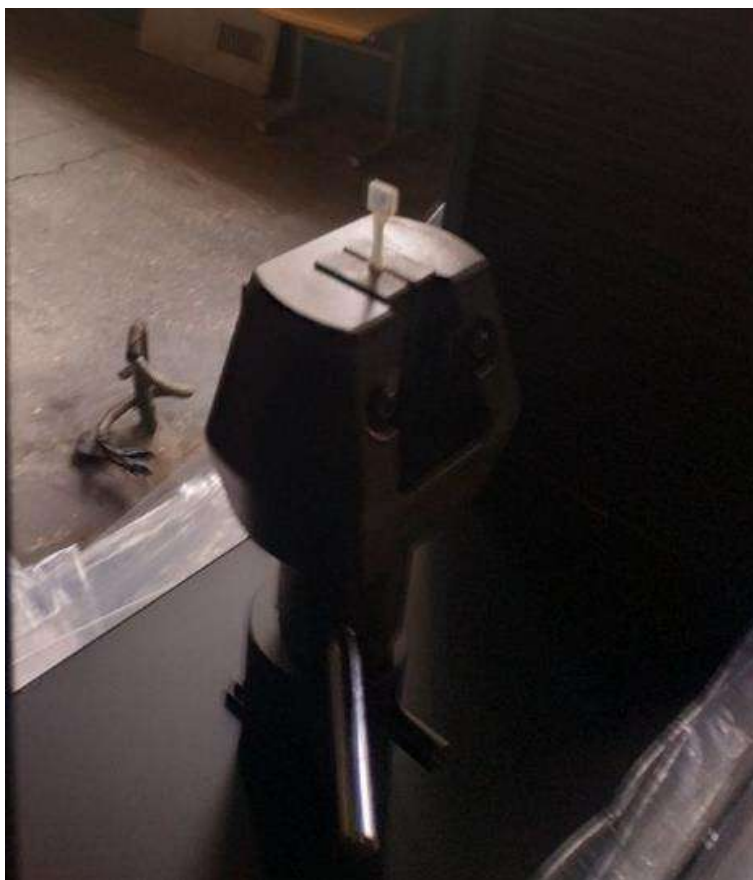
Рисунок 2.11 – Закріплення та положення зразка у випробувальній машині
