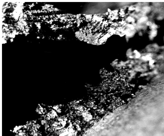
Рисунок 4.13 – Гаряча тріщина з боку внутрішнього (охолоджуваного) каналу лопатки зі сплаву ЖС26-ВІ
