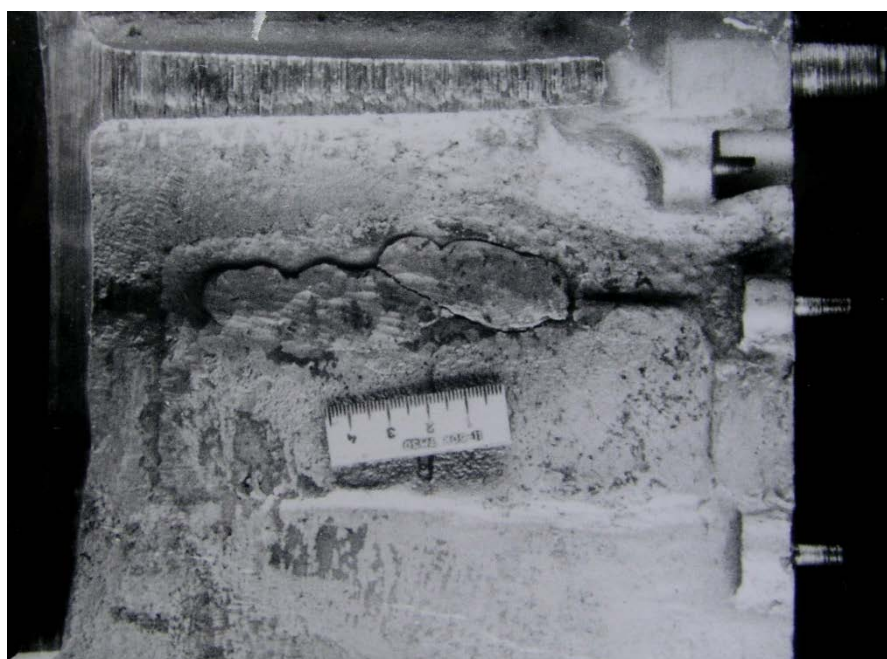
Рисунок 3.6 – Тріщина в місці заварки корпусної відливки; \times 0,3
