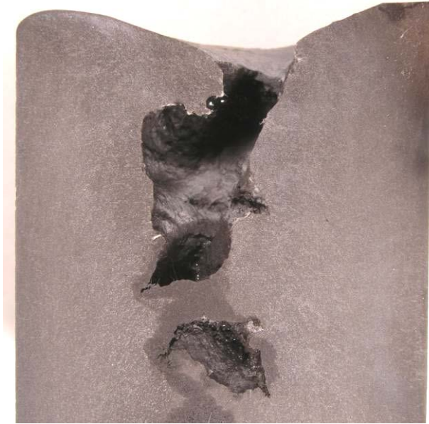
Рисунок 5.9 – Макроструктура верхньої частини пруткової заготовки діаметром 85 мм, відлитої зі сплаву ЖС32-ВІ (осьовий переріз)
