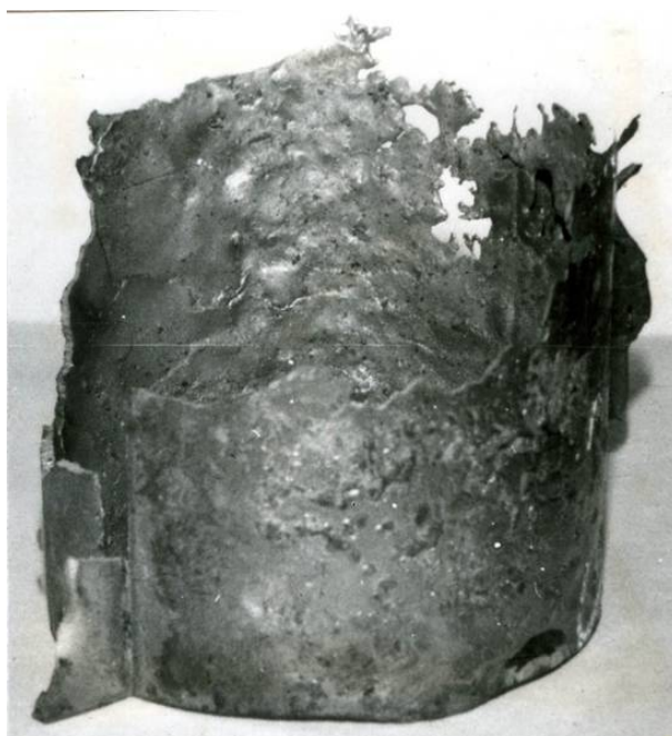
Рисунок 5.1– Зовнішній вид гарнісажного шару над верхньою частиною зливку ВІП+ЕПП
