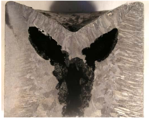
Рисунок 5.5 – Макроструктура в осьовому перерізі верхньої частини пруткової заготовки Ø 105 мм, відливої з металу ЖСЗЛС-ВІ з використанням фільтру
