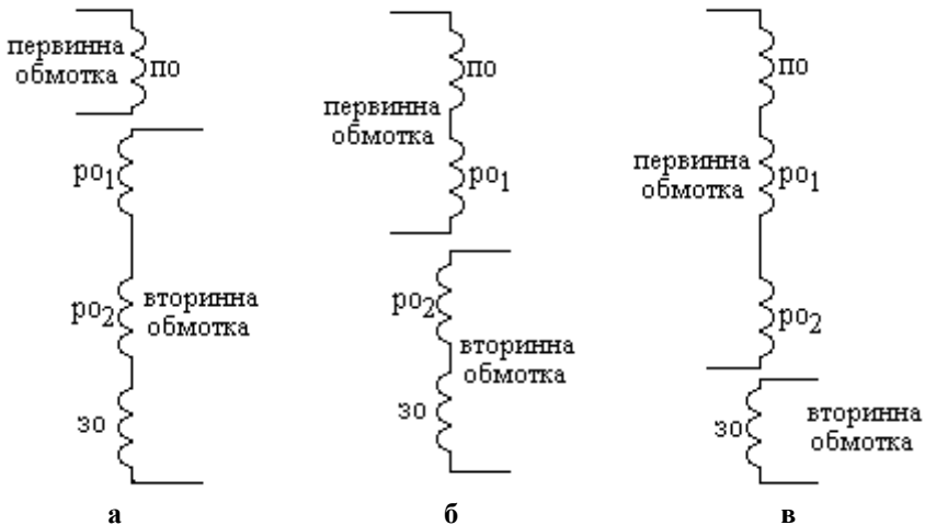
а – максимальна напруга на стороні НН; б – номінальна напруга на стороні НН; в – мінімальна напруга на стороні НН
