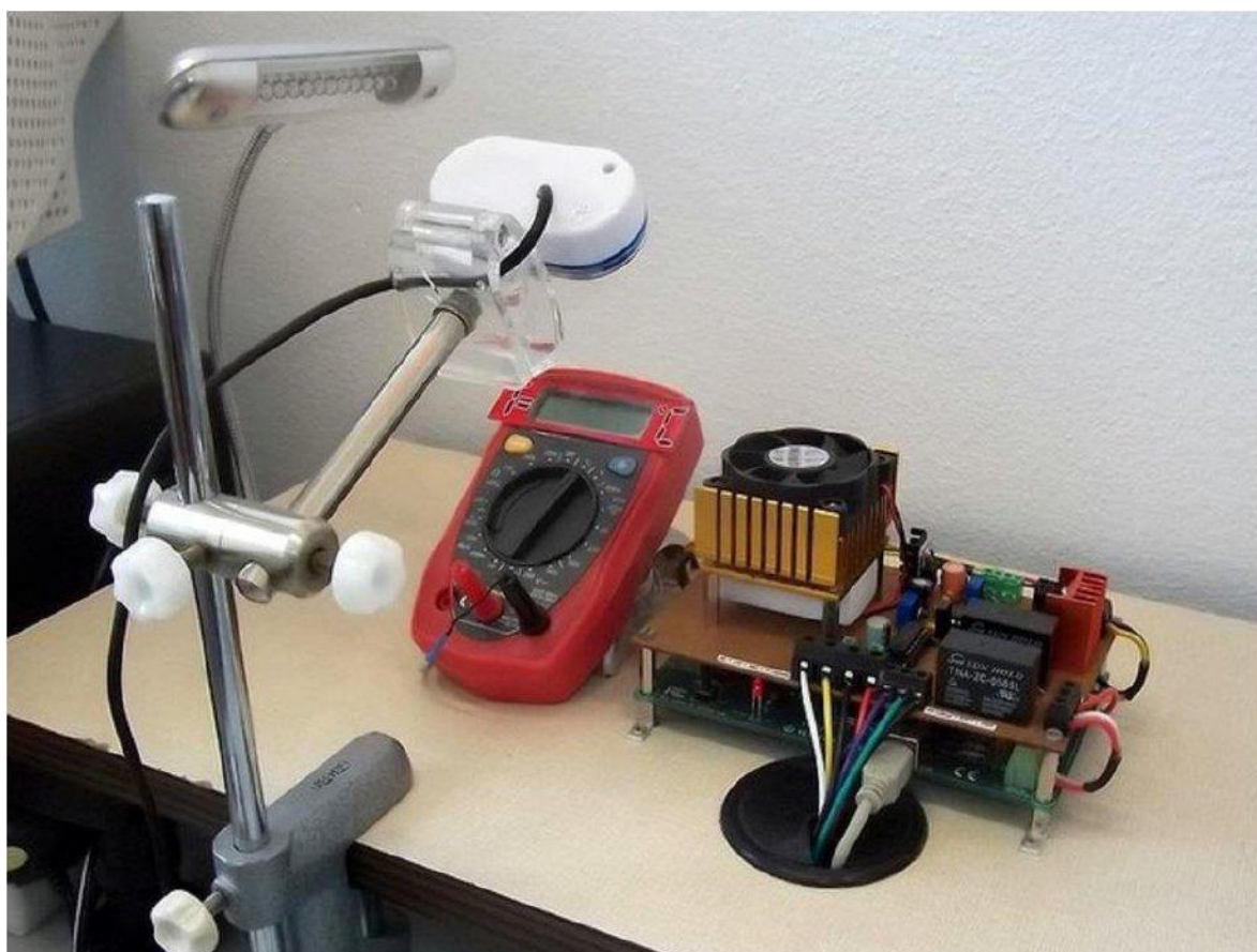
Рисунок 2.1 – Зовнішній вигляд лабораторної установки «Температура, залежності опору металів і напівпровідників»
