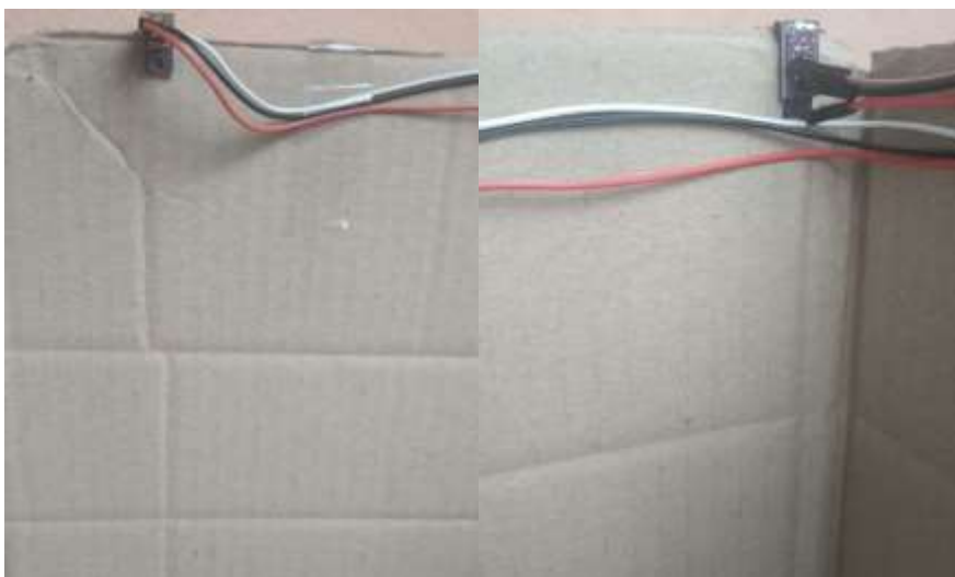
Рисунок 2.7 – Розміщення датчиків освітленості всередині макету
