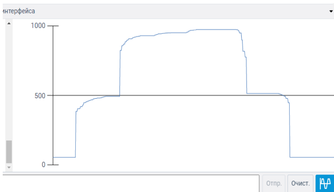
Рисунок 4.2 – Залежність освітленості вулиці від часу на платформі Tinkercad
