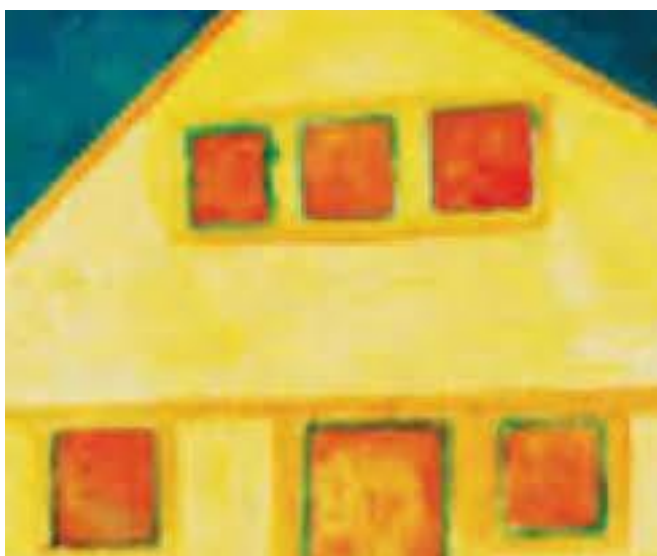
Рисунок 1.17 – Термограма з неізольованими зовнішніми стінами
