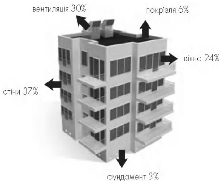
Рисунок 1.16 – Відсотки втрат тепла в багатоповерховому будинку
