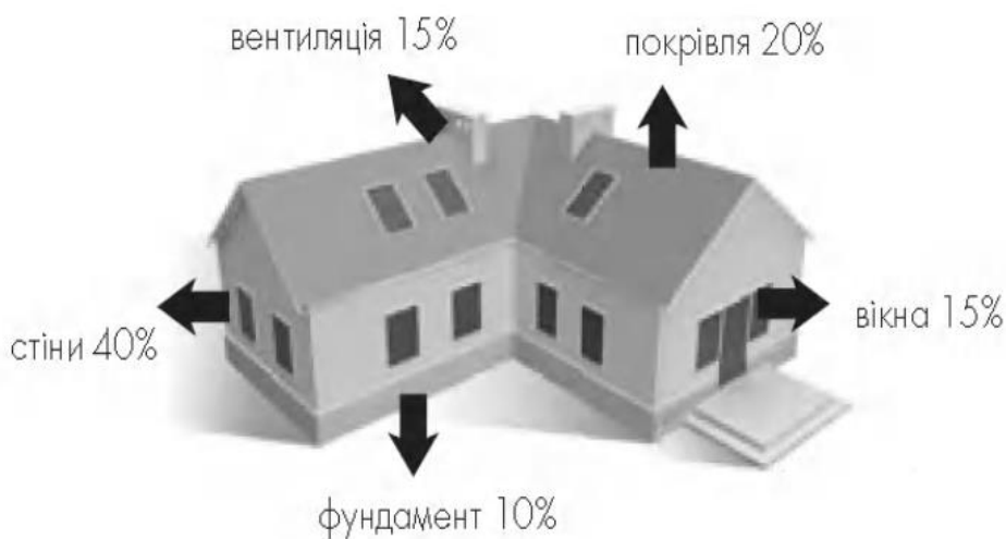
Рисунок 1.15 – Відсотки втрат тепла в одноповерховому будинку
