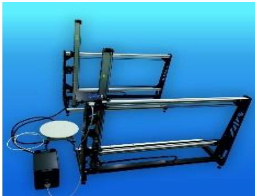
Рисунок 4.2 - Верстат для різання пінопласту з поворотним столом
