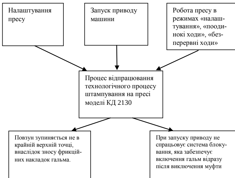
Рисунок 1 – Схема відпрацювання технологічного процесу штампування на пресі моделі КД 2130
