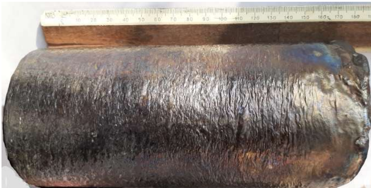
Рисунок 4.2 – Виливок з титану VT1-0
