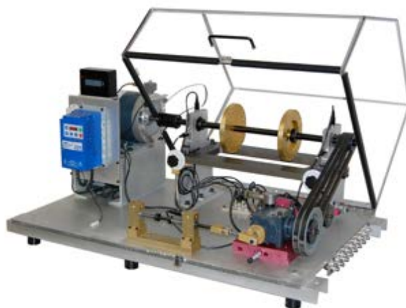
Рисунок 2.17 – Вигляд апаратури MFS, на якій проводилось збирання даних [50]
