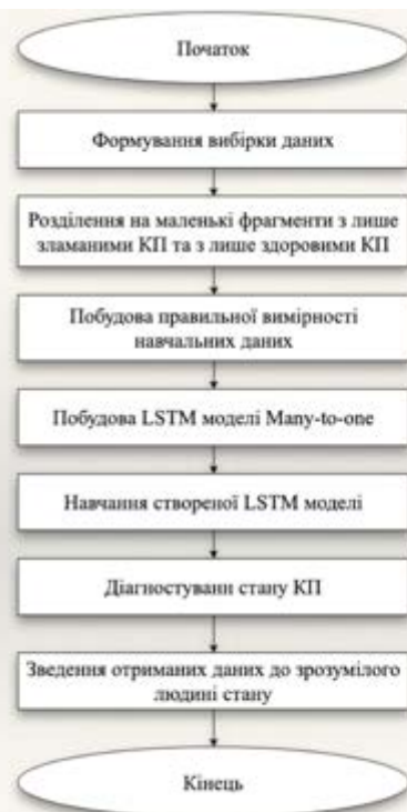
Рисунок В.5 – Слайд «Метод визначення технічного стану коробки передач»
