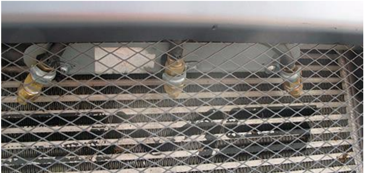
Рисунок 1.5 – Інтеркулер з форсунками для розпилення води на його поверхню
