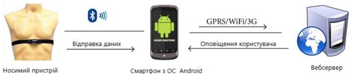
Рисунок 2.5 – Архітектура системи моніторингу [21]
