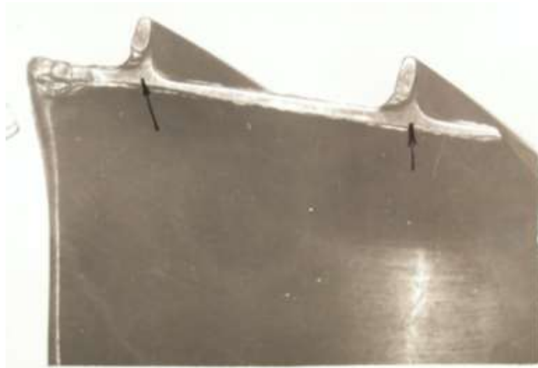
Рисунок 1.3 – Знос робочої лопатки 2-го ступеня турбіни після напрацювання 2458 годин
