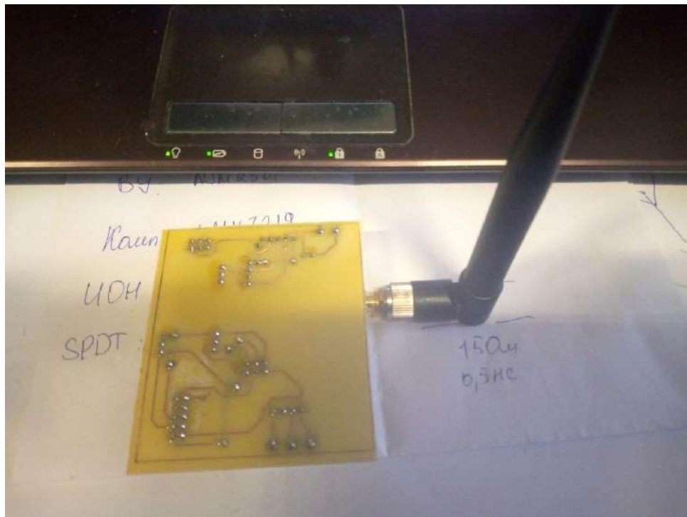
Рисунок 4.2 – З'єднувальна плата приєднана до контактів плати розробленого відеопередавача
