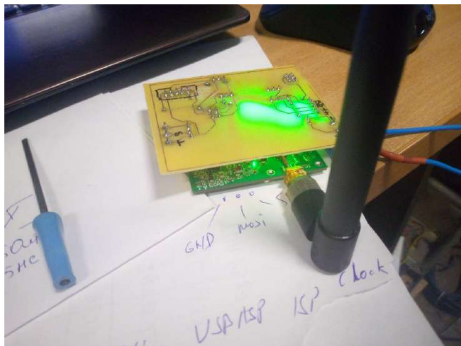
Рисунок 4.3 – Відлагодження програми керування мікшером за допомогою з'єднувальної плати
