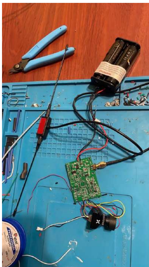
Рисунок 4.10 – Перший тест. Пропуск сигналу відео через плату на пристрій відображення
