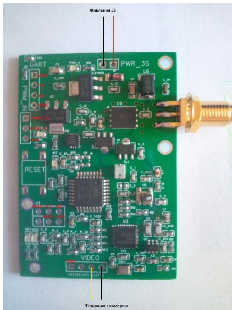
Рисунок 4.7 – Позначення контактів на відеопередавачі, що використовувались для відлагодження його роботи
