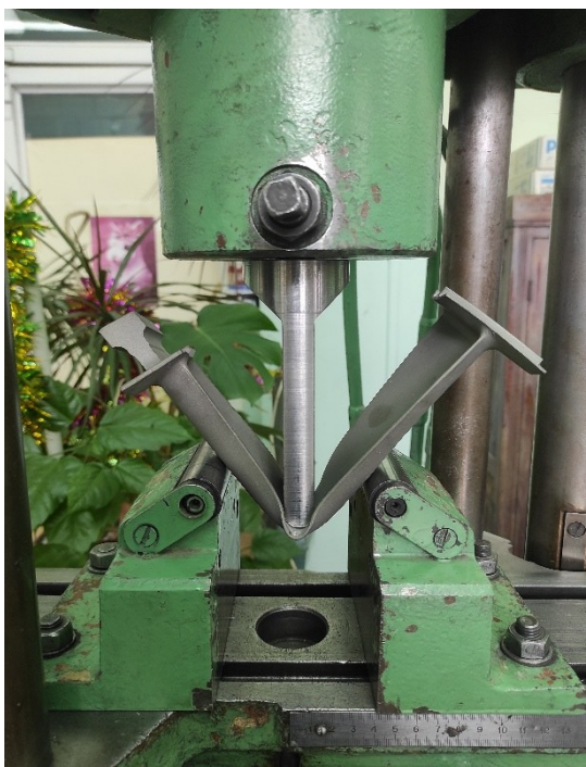
Рисунок 2.3 – Випробування лопаток ТВ на кут загину
