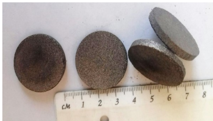
Рисунок 2.2 – Брикетований модифікатор – карбонітриду титану Ti(C,N)
