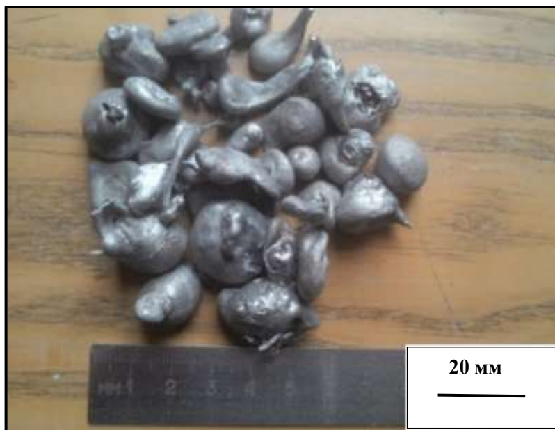
Рисунок 4.2 – Зовнішній вигляд дрібнокристалічної шихти
