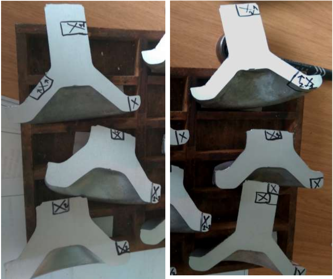
Рисунок 5.2 – Макрошліфи деталей 05943200001-01 «Тарілкоотримач»
