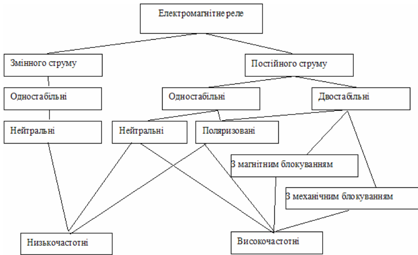
Рисунок 1.1 – Класифікація електромагнітних реле
