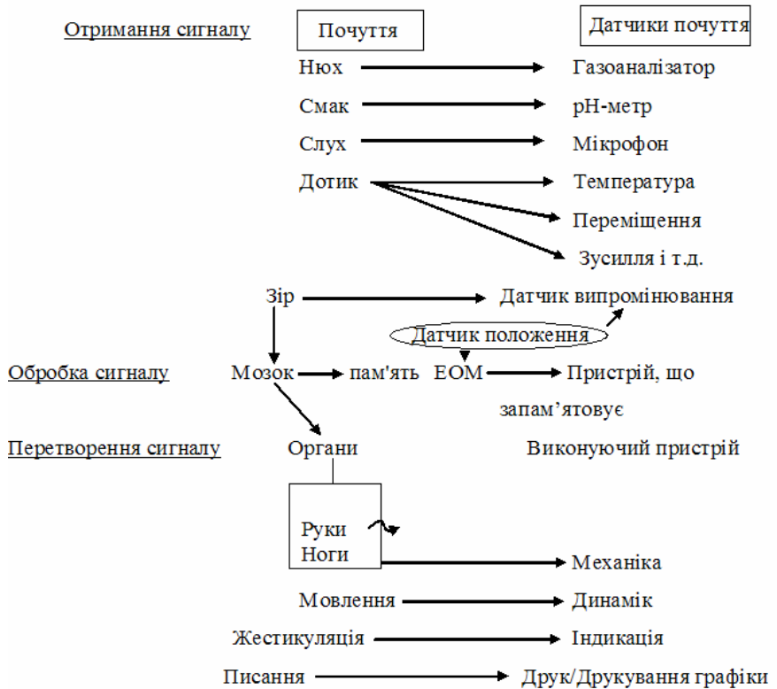
Рисунок 2.3 – Аналогія функціонального зв'язку між процесами отримання, обробки і перетворення сигналів в біологічних (людина) і технічних (автомат) системах
