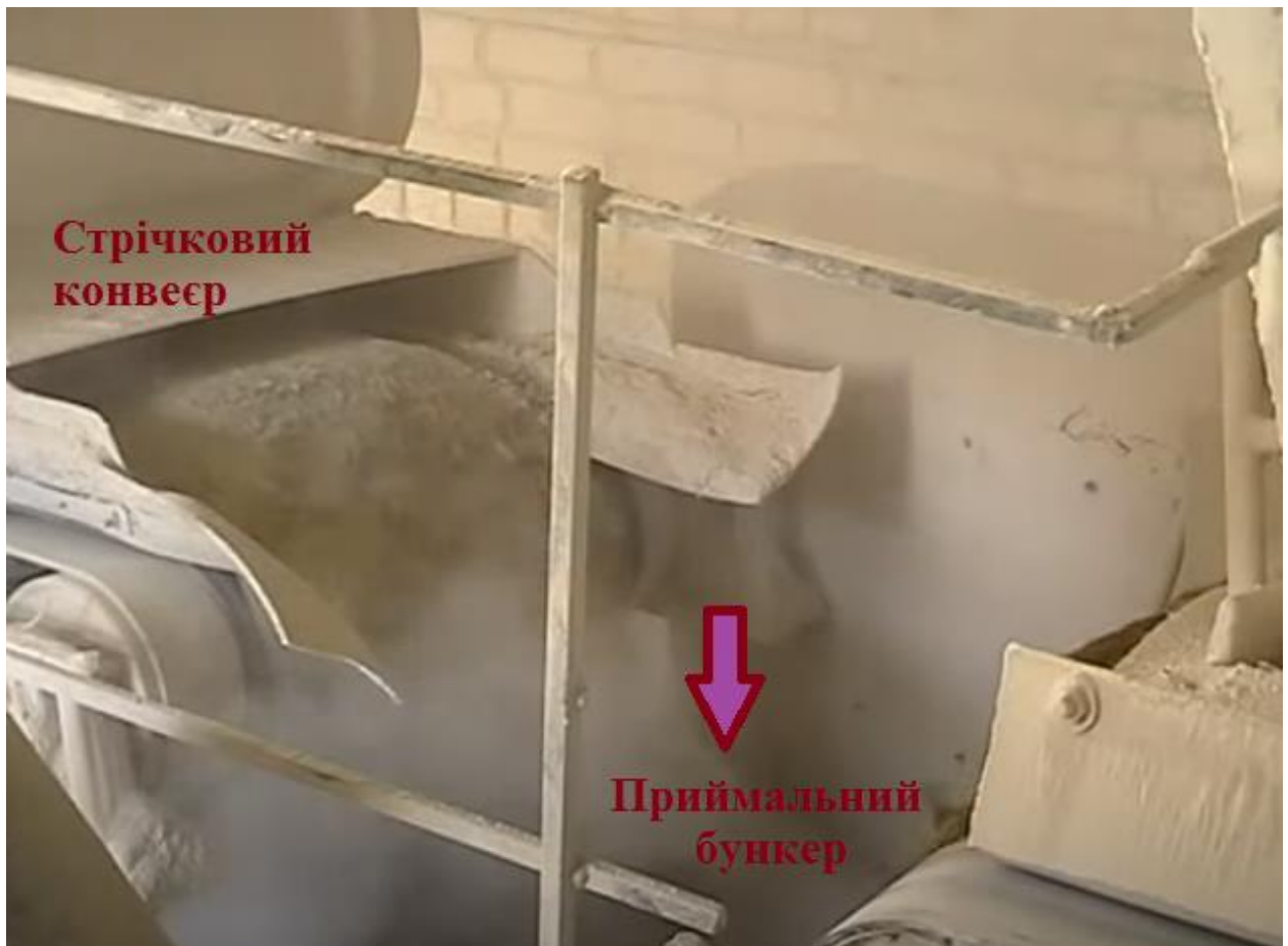
Рисунок 1.5 – Подача сировини стрічковим конвеєром до приймального бункера
