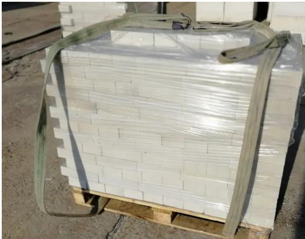
Рисунок 2.3 – Розміщення цегли на піддоні з виходом вантажу за його межі
