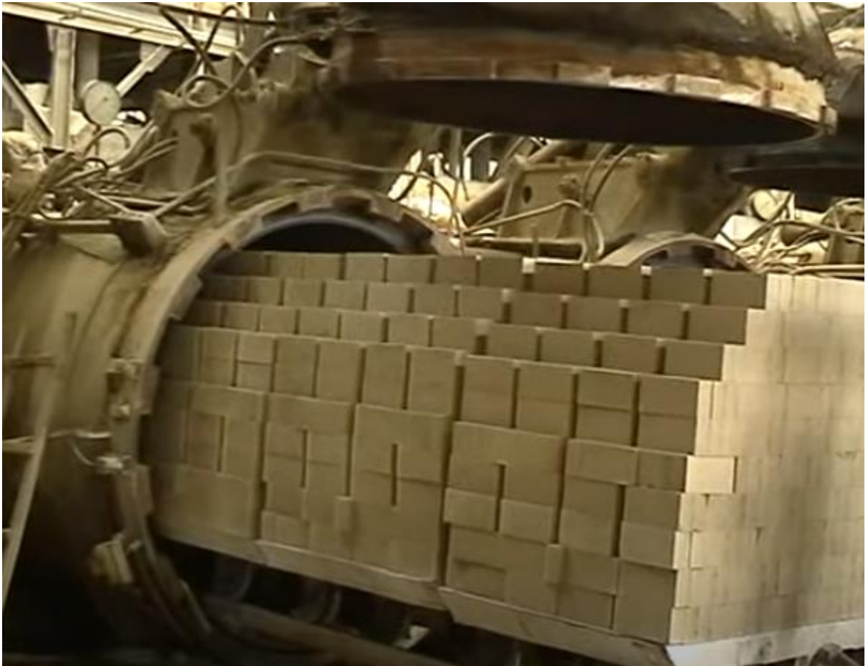
Рисунок 1.7 – Процес завантаження цегли до автоклаву
