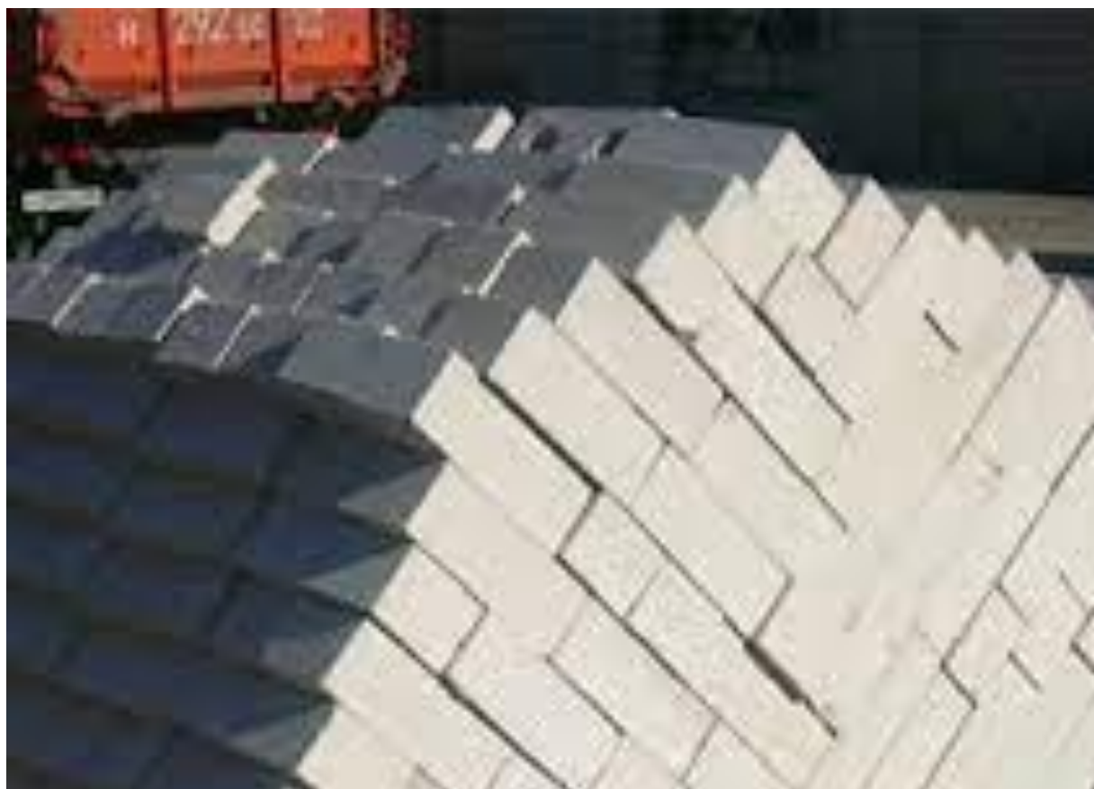
Рисунок 2.2 – Метод укладання цегли на піддони під кутом 45^\circ
