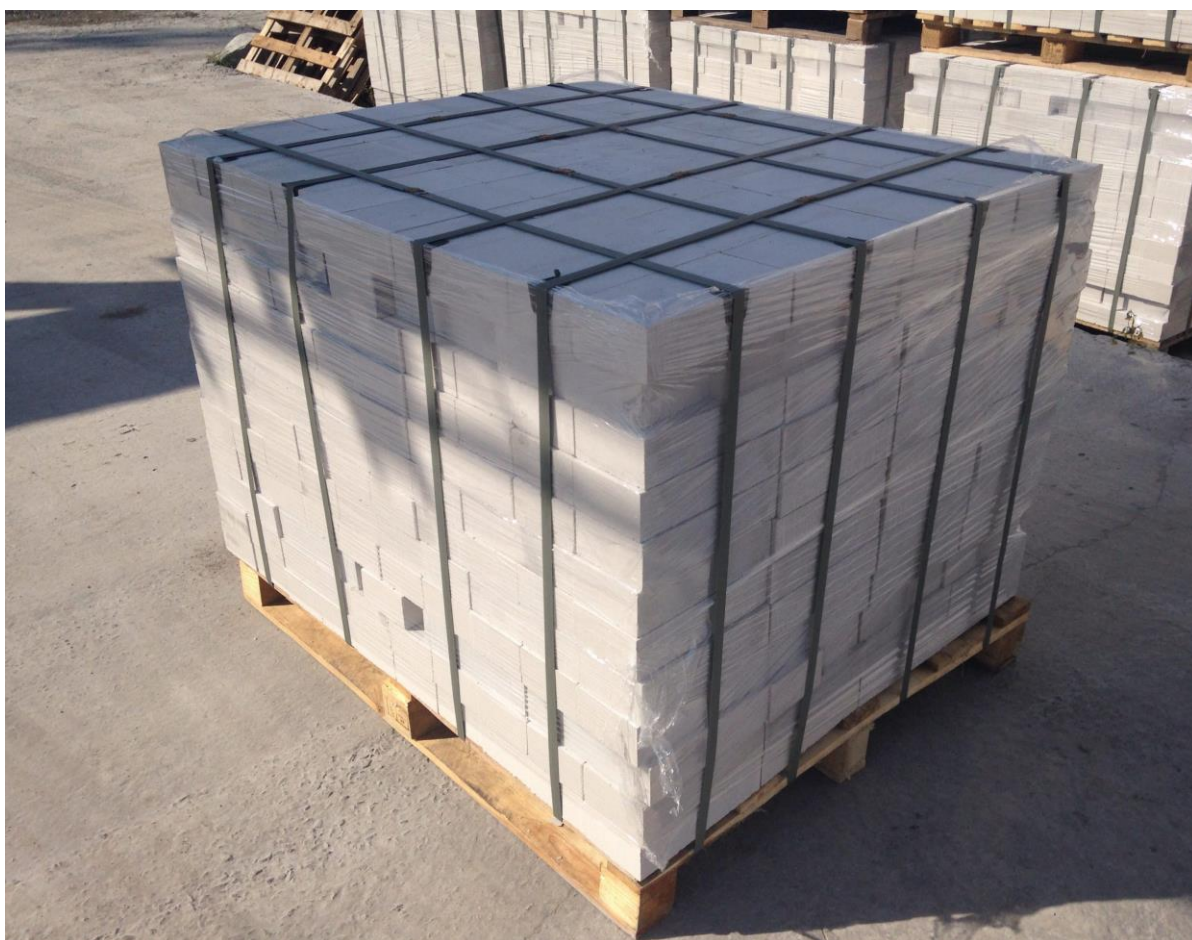
Рисунок 2.1 – Розміщення цегли на європіддоні
