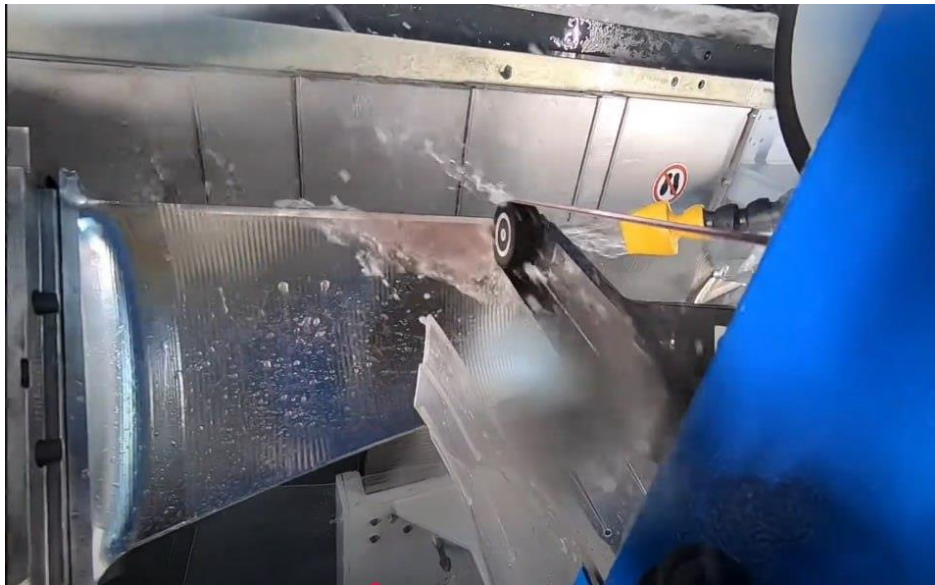
Рисунок 1.9 - Процес стрічкового полірування
