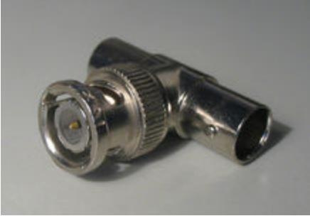
Рисунок 1.2 – Т-коннектор формату BNC
