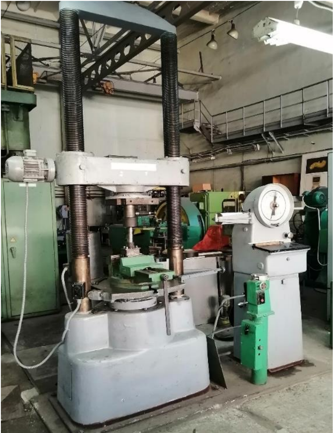
Рисунок 3.8 – Процес проштовхування трубної заготовки на гідравлічному пресі ПГ-100А
