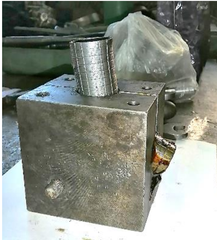
Рисунок 3.9 – Закінчення процесу прошивування трубної заготовки (а) та готовий виріб в складальних матрицях (б)
