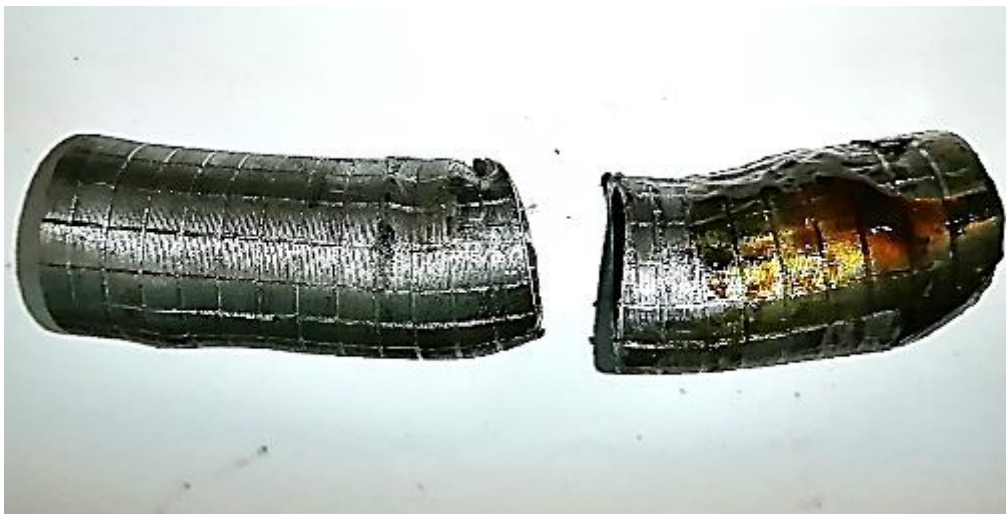
Рисунок 3.11 – Розрив трубної заготовки на 2 частини в цій же середній частині по ходу нанесеної сітки та овалізації країв на виході
