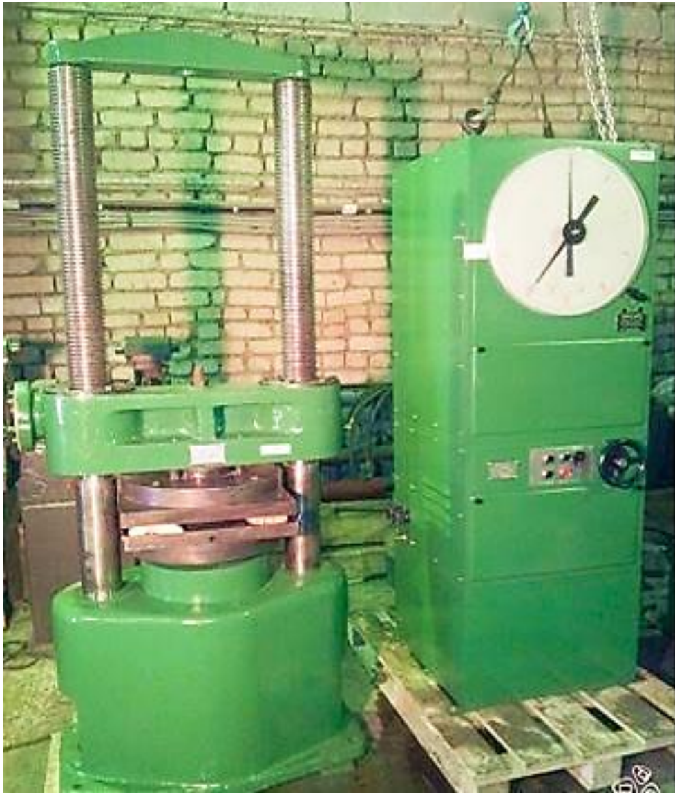
Рисунок 2.1 – Загальний вид гідравлічного пресу ПГ-100А
