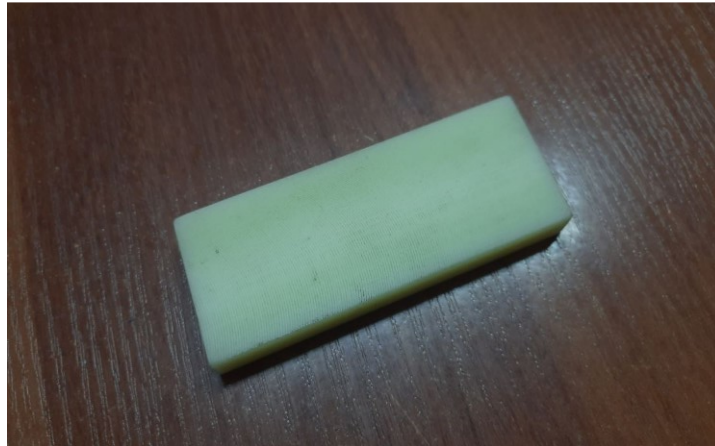
Рисунок 3.9 - Заготовка з поліаміду під фрезерування
