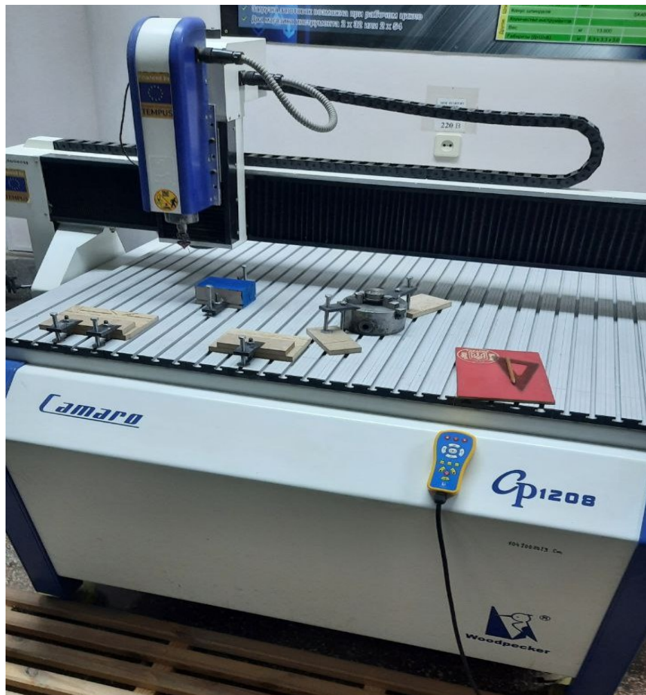
Рисунок 3.3 - фрезерний верстат з ЧПУ Camargo CP1208
