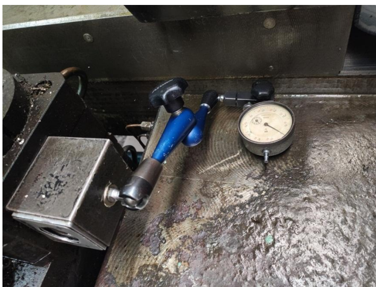
Рисунок 4.9 – Закріплення годинникового індикатора
