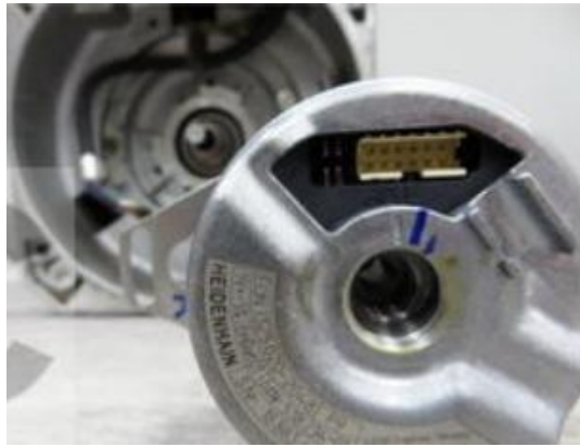
Рисунок 3.2 – Енкодер та місце його встановлення
