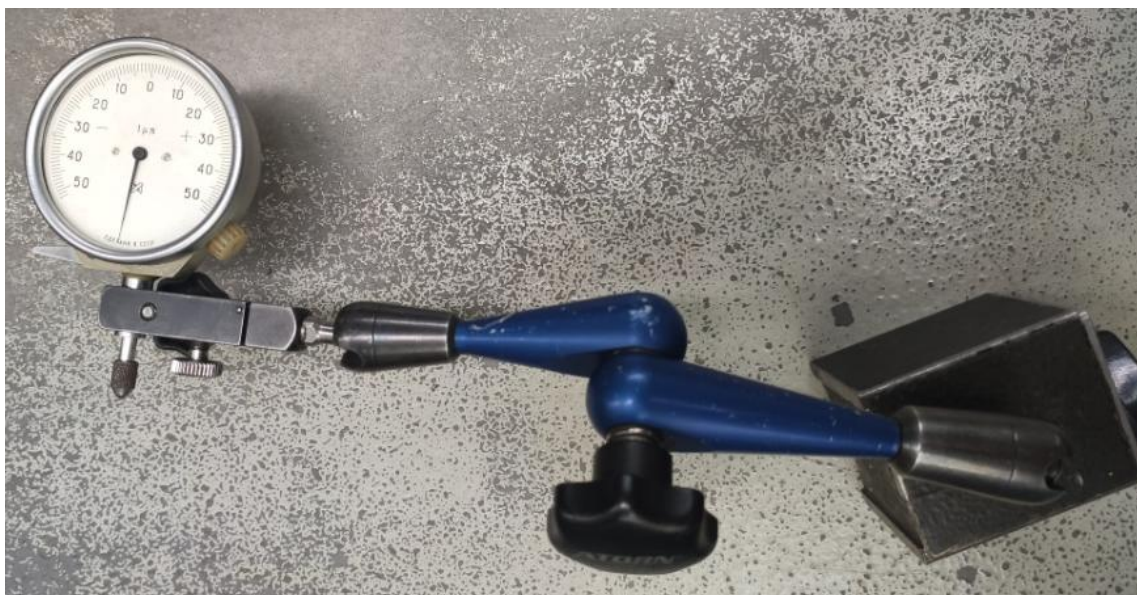
Рисунок 4.2 – Магнітна стійка з годинником
