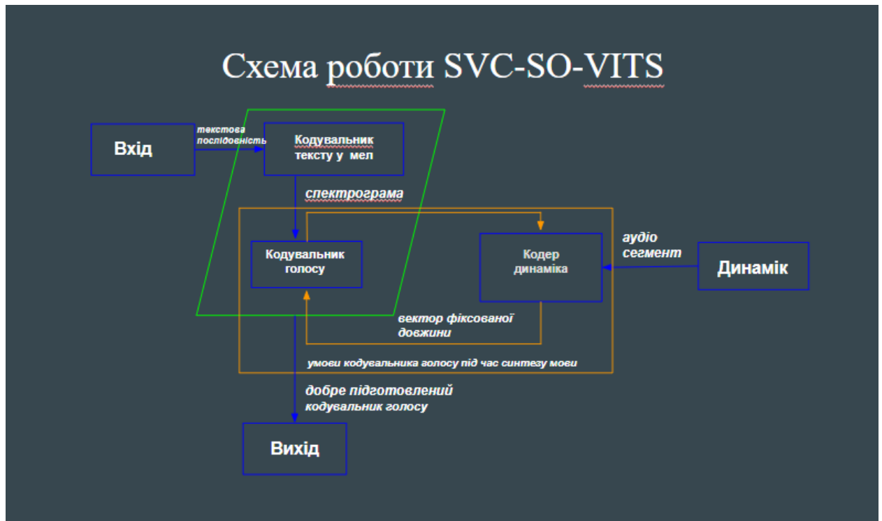
Рисунок 4.2 – Схема роботи з навченою голосовою моделлю
