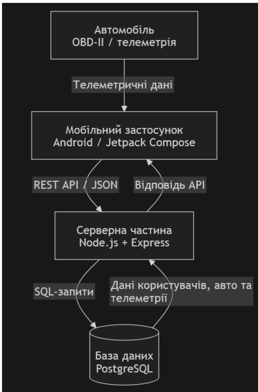
Рисунок 2.1 - Схема структури системи моніторингу автомобіля
