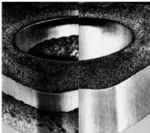
Рис. 1.35 Порівняння поверхні звичайного і чистового вирубання-пробивання.
